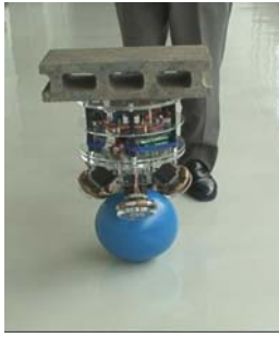
(a) ロボットにコンクリートブロックを載せ，指で動かす．
